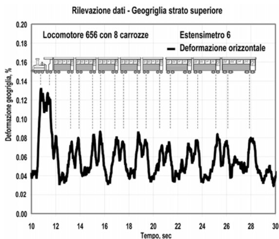
Figura 3: dati rilevati durante il passaggio del treno dall'estensimetro n. 5 (a) e 6 (b) installati sulla parte superiore della geogriglia a 0.30 m di profondità.
