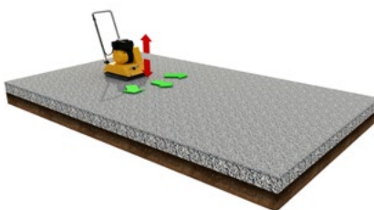
5. Procedere con la compattazione dello strato superficiale
