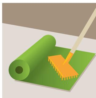
Srotolare il prato sintetico e rialzare le fibre appiattite con uno spazzolone a setole dure, ripetendo l'operazione più volte.
