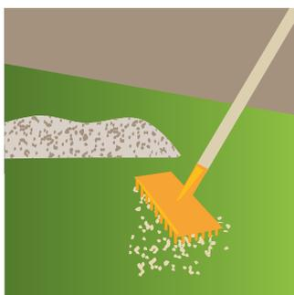
Attendere 24 ore di asciugatura e distribuire, se necessario, della sabbia utilizzando uno spazzolone a setole dure e facendo penetrare la sabbia a fondo.
