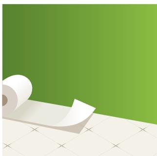
**1) SU PAVIMENTO:** Fissare i bordi laterali con del biadesivo tipo Tenax MAT DUO\*.
