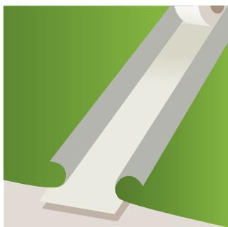
Per giuntare due rotoli, affiancare i teli, verificando la stessa direzione delle fibre ed il perfetto accostamento. Risvoltare entrambi i bordi e procedere con la stesura di un nastro adesivo tipo Tenax MAT SEAL (o di striscia di tessuto non tessuto tipo MAT STRIPE sul quale andare a disporre un collante poliuretano). Ristendere infine i bordi.
