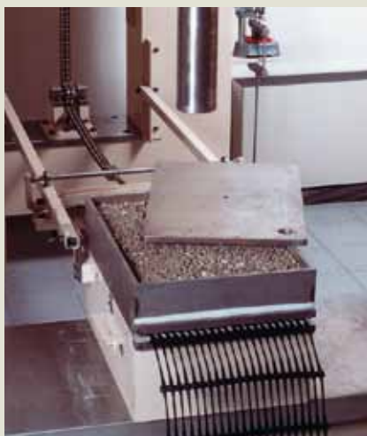
Prova di taglio eseguita presso il laboratorio di TENAX SpA.
